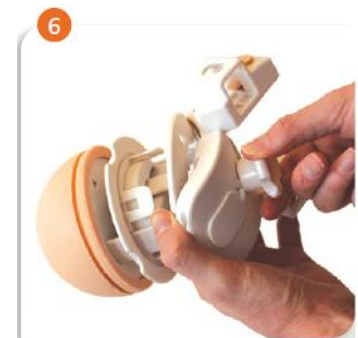
ชิ้นส่วนตัวล็อคส่วนล่างถูกปลดออกอย่างสมบูรณ์
